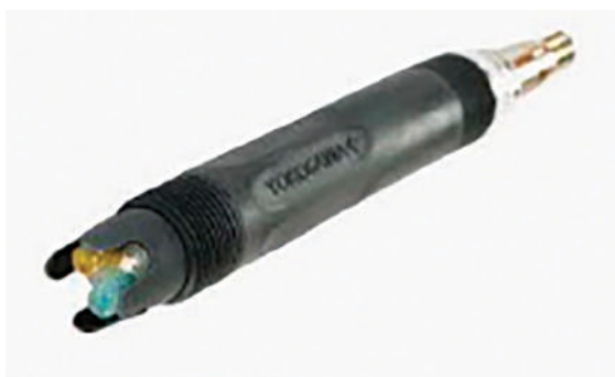
pH/ORP (Oxydo Reduction Potential) pH болон исэлдэн ангижрах потенциал
