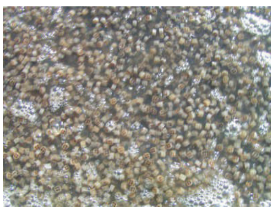
Зураг 19: Био өнгөр тогтоогчтой реактор
