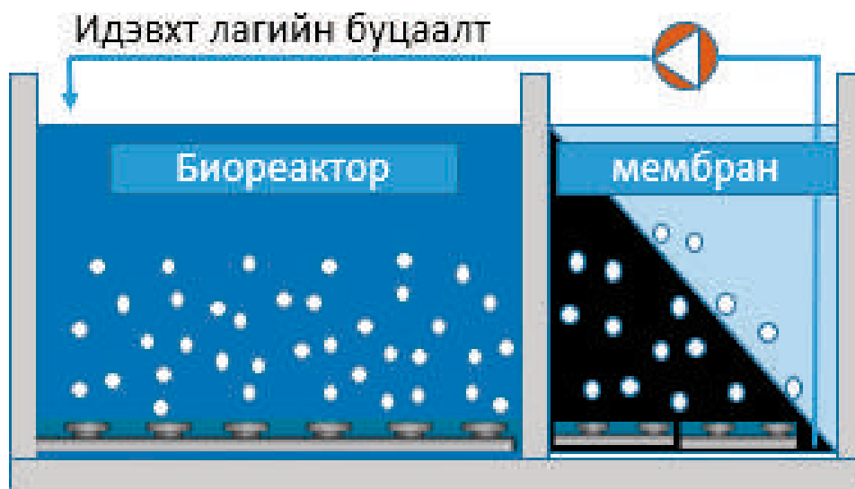
Зураг 22: Мембран биореактор (МБР)-ын схем
